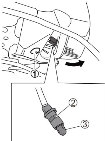
松开前大灯光束调节器螺栓 ①，把前大灯向前移动。捏住插座的橡胶部分 ② 取下插座。从插座上取下灯泡 ③。
