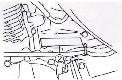
车架号码和发动机序号码用于登记摩托车。当订购零部件或特殊服务时，此编号将能帮助经销商为您提供更好的服务。车架号码①打印在前立管右侧。发动机号码②印在曲轴箱组件上。
