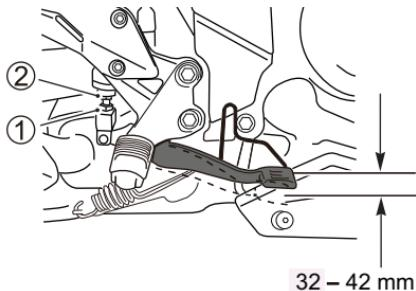
1. 松开锁紧螺母 ①，转动推杆 ② 以定位踏板位置在踏板最高位置下方 32-42mm。
