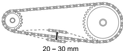
在两个链轮的中部检查传动链条的松弛度。根据您的骑行情况,传动链条比定期点检周期需要更加频繁的调整。
