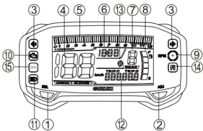
当发动机转速达到预设的发动机转速时，发动机转速计指示灯⑨点亮或闪烁。
