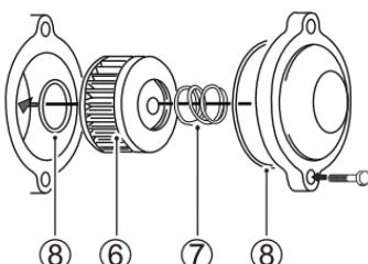
8. 在重新安装发动机机油滤芯盖之前，确认机油滤芯弹簧⑦和O型圈⑧安装正确。
