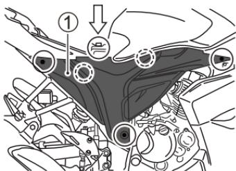
拧下螺丝钉。松开车架右罩 ① 挂钩，取下车架右罩。
