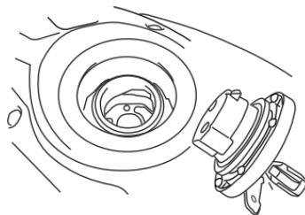
如需打开油箱盖，则插入点火钥匙将其逆时针方向旋转，不取下钥匙，转动并用钥匙取下油箱盖。如需关闭油箱盖，则将其顺时针方向旋转直到盖子上的三角形标志与托盘三角形标志对准。
