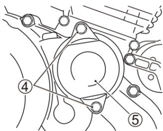
6. 取下两个机油滤芯盖安装螺栓④，同时拿住机油滤芯盖⑤。
