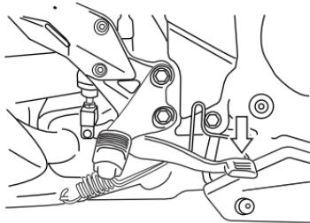
踩踏后制动踏板会使后制动发生作用。在后制动发生作用时制动灯点亮。
