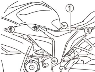
3. 拧下螺丝钉。松开车架左罩 ① 挂钩，取下车架左罩。
