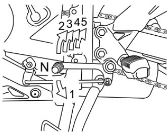
本款摩托车是 5 档变速，变档操作如上图所示。握紧离合器手把、关闭油门，同时操作变档杆以实现顺利变档。挑起变档杆向上变档，踩踏变档杆向下变档。空档设在 1 档和 2 档之间。当需要变成空档时，踩踏或上挑变档杆大致在 1 档和 2 档之间。
