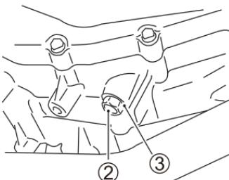
3. 将集油盘放在放油螺塞 ② 下面。
