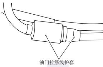
油门拉筋线配备保护罩。检查保护罩是否牢固安装。清洗时请勿直接将水撒到保护罩上。保护罩变脏时，用湿布将其上的灰尘擦掉。
