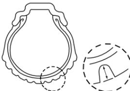
每天骑行前检查轮胎的状态。如果轮胎有明显损坏，例如：裂纹或切口，或者如果轮胎的前胎纹深度和后胎纹深度都小于 0.8 毫米，则应进行更换。
