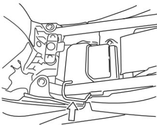
在座位下方有一个头盔挂钩。使用头盔挂钩时，先取下鞍座，把头盔锁扣挂在挂钩上再装上鞍座。
