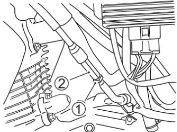
1. 松开锁紧螺母 ①，转动调节器 ②使离合器手把游隙达到正确的范围。
