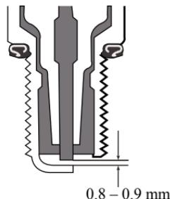
使用火花塞间隙规再次将火花塞间隙调整到 0.8 至 0.9 毫米。定期清理火花塞上的积炭。
