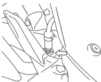
调整制动指示灯开关时，握紧开关本体，转动调节器以使制动指示灯在
