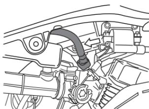
先松开与空气滤清器相关部位,再取下右边盖。检查燃油软管是否损坏并存在燃油泄漏。一旦发现任何缺陷,则应更换燃油软管。
