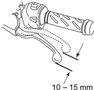
在离合器手把的端部测量时，离合器手把的游隙应该为10-15mm。如果您发现离合器手把游隙不当，请按如下步骤调整。
