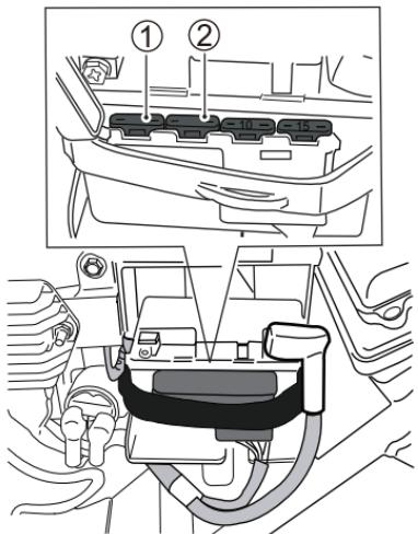
保险丝位于左边盖后面。检修保险丝拆卸左边盖，请参照蓄电池章节的内容拆除蓄电池箱盖。
