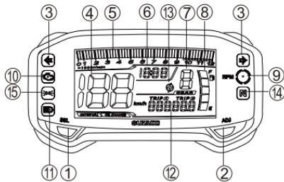
当点火开关置于 ON 位置时, 请按如下步骤确认发动机转速指示灯⑨、故障指示灯⑩ (选配) 和 LED 的工作状态和性能。
