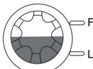
4. 松开中心支架，垂直扶住摩托车，并通过发动机右侧的机油检查窗口检查机油的油位。
