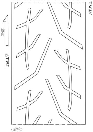
注：“*T.W.I.△*”标记表示耐磨条模制到轮胎中的位置。当耐磨条接触地面时，表明轮胎已达到磨损极限。
