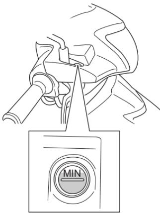
检查贮液盒中制动液的液位。如果贮液盒中制动液液位低于下限，请检查垫片是否磨损和泄露。
