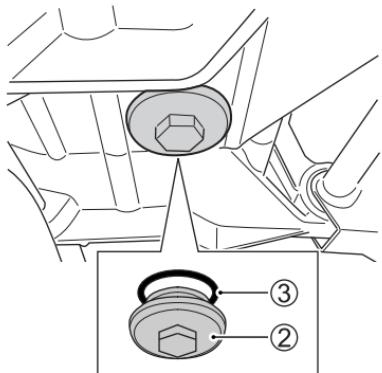
4. 用扳手拆下放油螺塞②和“O”型环③，并在垂直扶住摩托车时排出机油。
