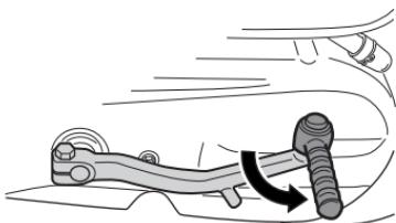
此摩托车配备了反冲起动杆，位于发动机的左侧。启动发动机，并用中心支架停稳摩托车，用力踩踏反冲起动杆。
