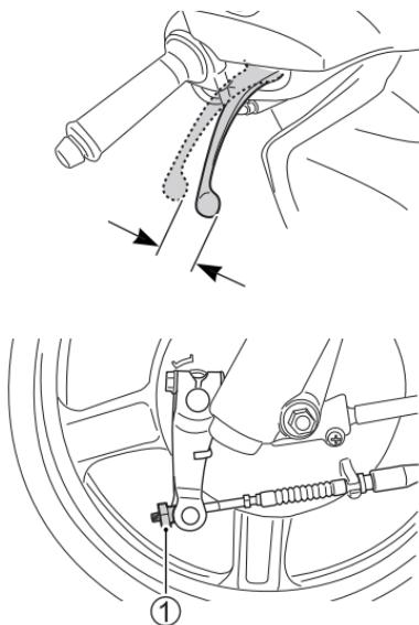
经在制动手柄末端测量，制动手柄轻拉至油门转把时，前制动手柄间隙应为 15-25 毫米。每次骑行前检查该间隙，如有必要可进行如下调整：
