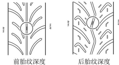
注：“ $\triangle T.W.I.$ ”标记表示耐磨条模制到轮胎中的位置。当耐磨条接触地面时，表明轮胎已达到磨损极限。
