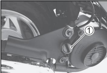
3. 拆下发动机底部的放油螺栓，将发动机内部的旧机油排出；
