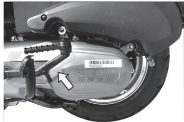
本车装有反冲启动杆位于发动机左边。当启动按钮无法正常工作时可使用反冲启动杆启动车辆。
