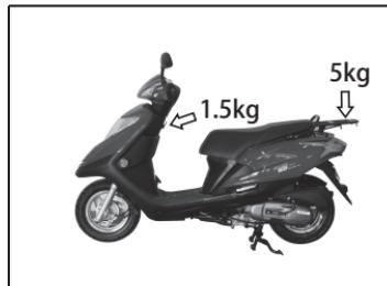
后货架的载物重量不得超过 5 kg，头盔挂钩的载物重量不得超过 1.5 kg。
